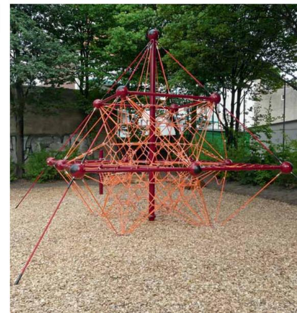
Klettern im freien Raum – dieses Gefühl ermöglicht der Pluto. Der Toppunkt des Gerätes wird durch einen durch das räumliche Netzwerk verlaufenden Zentralmast getragen. Die Abspannpunkte der jeweiligen Spielebenen werden durch einen umlaufenden Rahmen aus dem Framework-Raumfachwerksystem gebildet.
